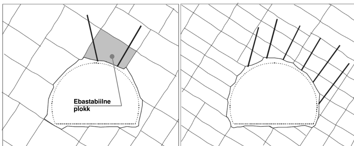
Joonis 5.1. Ebastabiilsete a) – plokkide ja b) – kihtide ankurpoltvooderdus
